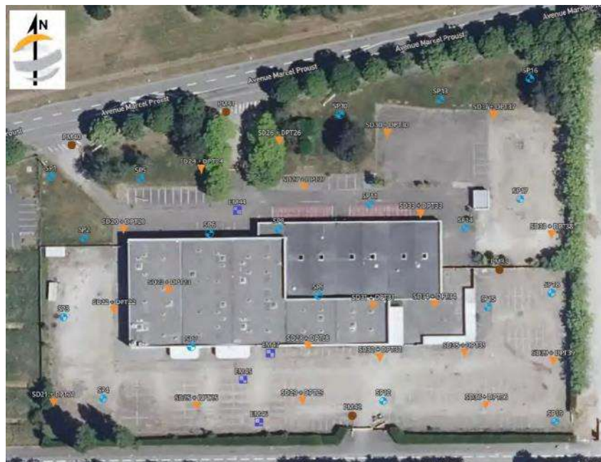
Figure 21 : plan d'implantation des tests de perméabilité sur le site d'étude - données étude géotechnique G1+G2 AVP - Fondasol - mars 2022
