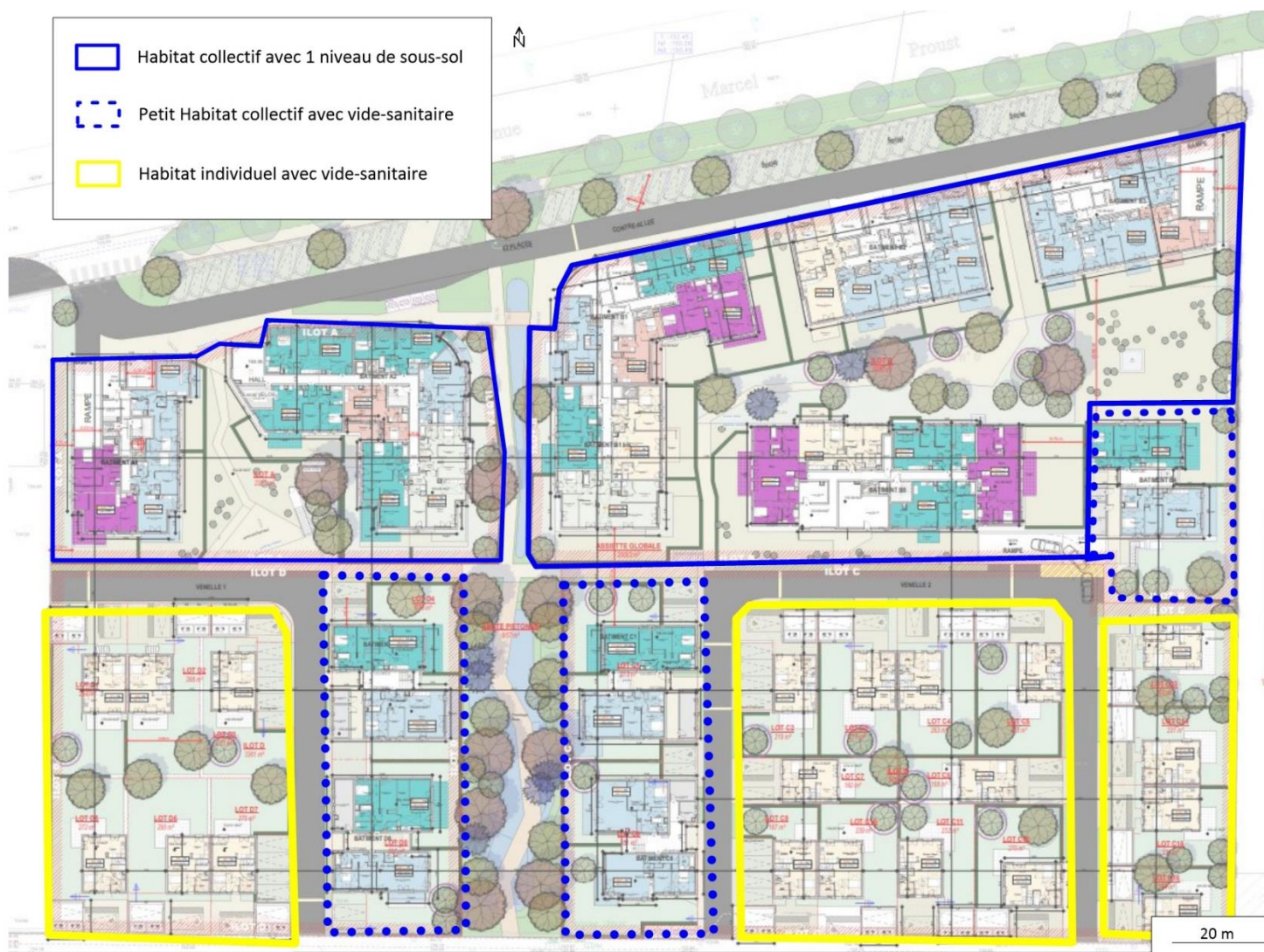
Figure 5 : Plan d'aménagement du site (Source : Maître d'ouvrage)
