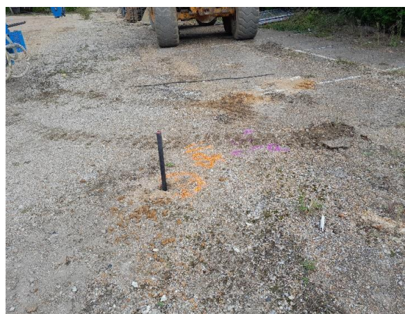
Piézair en place (avant cimentation)
