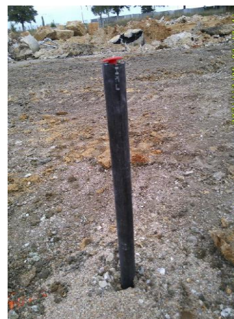
Piezair en place (avant cimentation)
