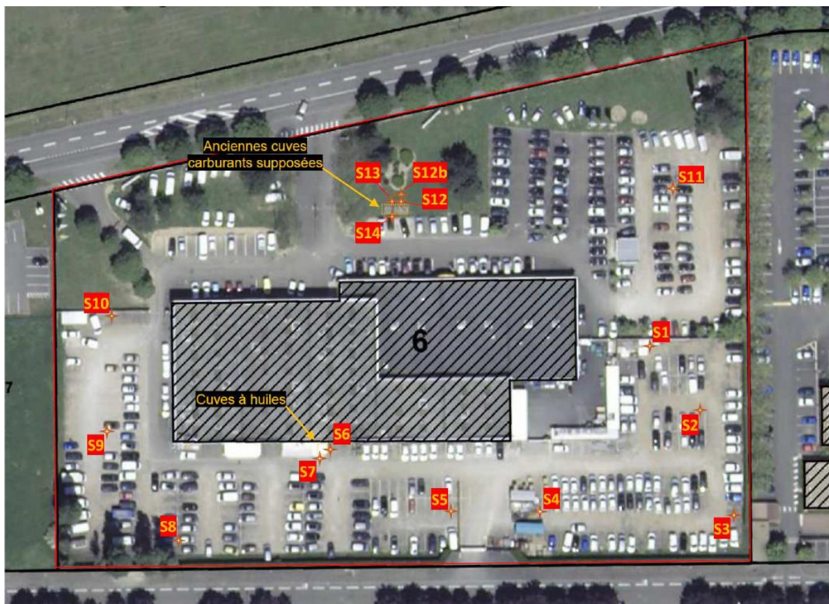
Figure 4 : Cartographie de l'occupation du site, des sources de pollution potentielles identifiées dans le rapport de diagnostic simplifié de 2014 et des sondages de sol réalisés (source : extrait du rapport de 2014)
