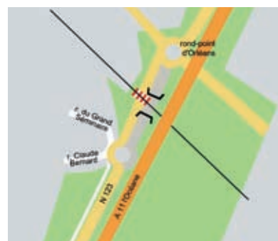
Avril 2014 à mars 2015 : construction de la chaussée souterraine, du pont, de la 2x2 voies et du nouveau rond-point.
