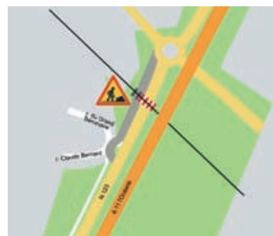
Construction de la déviation temporaire avec passage à niveau et création d'un nouveau rond-point : circulation normale.
