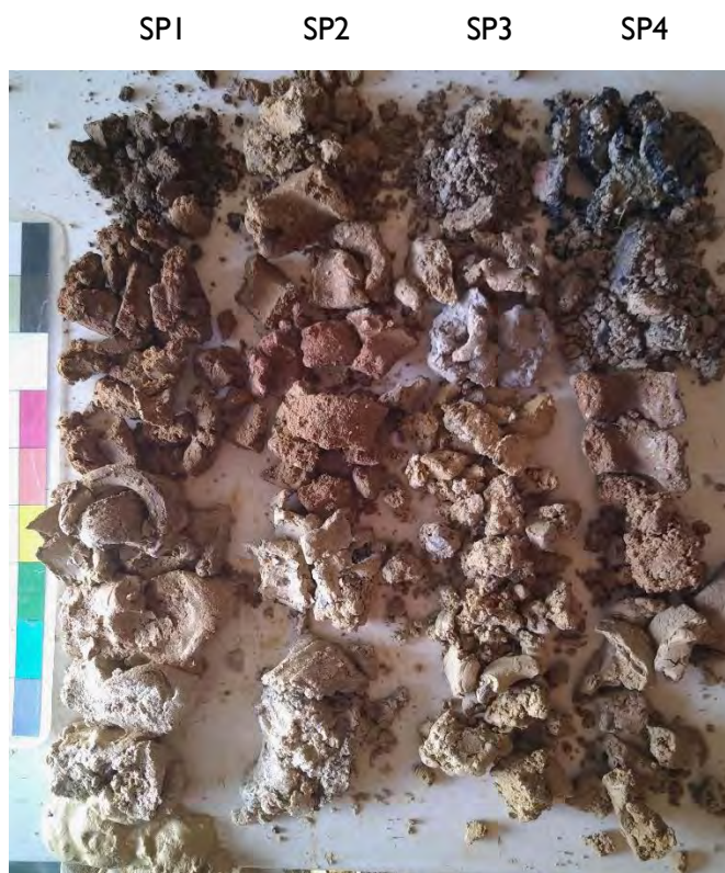
Photographie des cuttings prélevés à la tarière (sans flash, avec projecteur)
