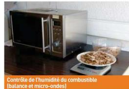
Contrôle de l'humidité du combustible (balance et micro-ondes)
