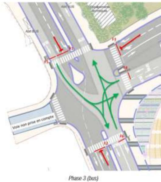
FIGURE 96 : PHASAGE DE MODIFICATION DU FONCTIONNEMENT DU CARREFOUR « RUE CASANOVA X VOIE NOUVELLE »
