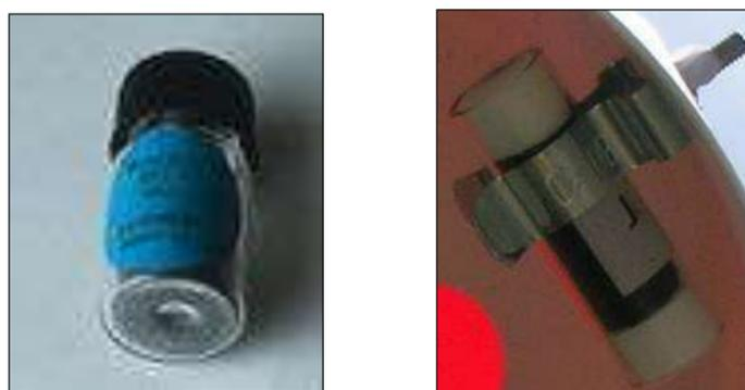
FIGURE 124 : TUBE POUR MESURER LES BTEX
