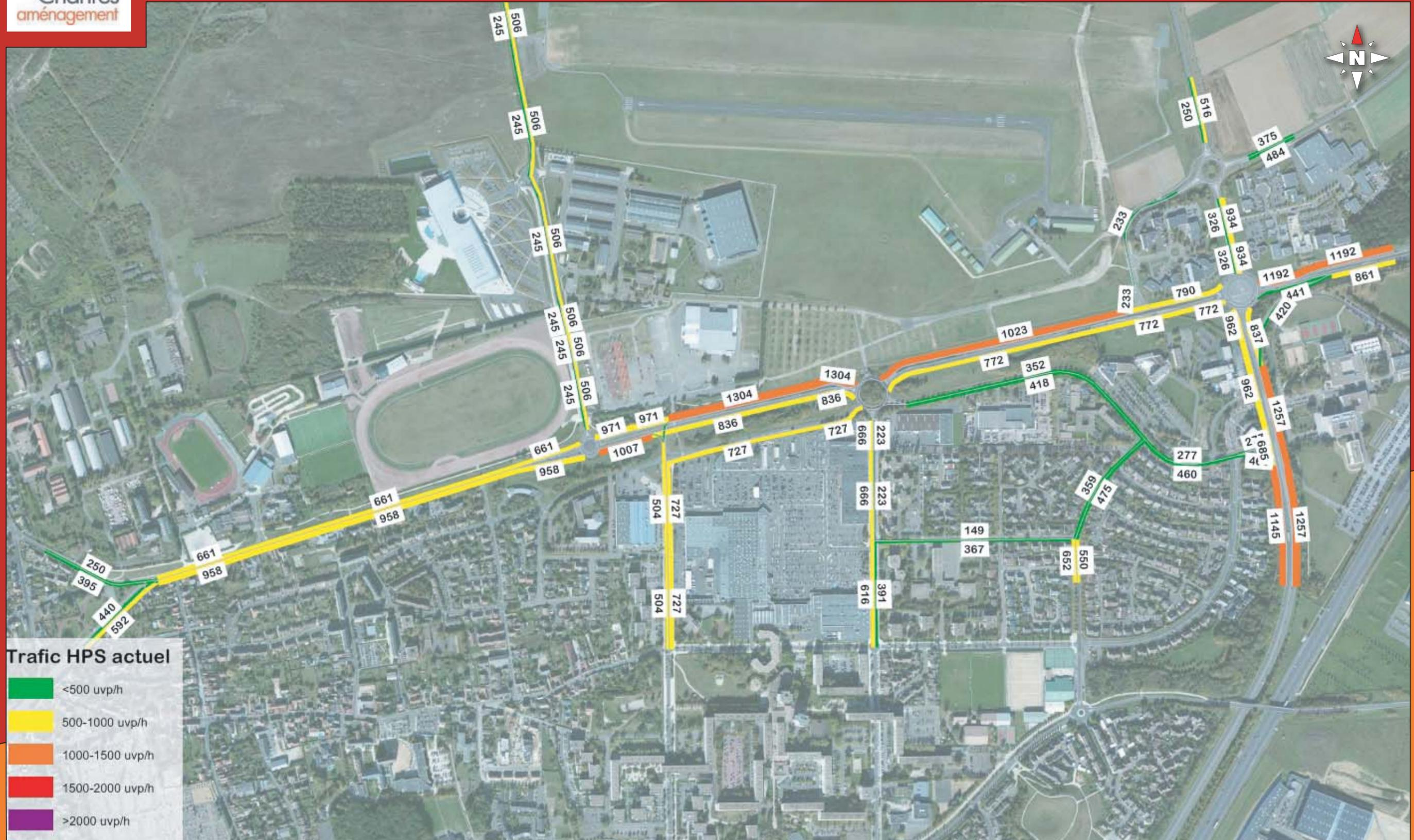
La modélisation de la saturation (différence entre le trafic recensé et la capacité de la voie) permet de mettre en avant les problèmes ponctuels constatés sur la RD910/voie de la Liberté avec un niveau de saturation oscillant entre 30 et 60%.
